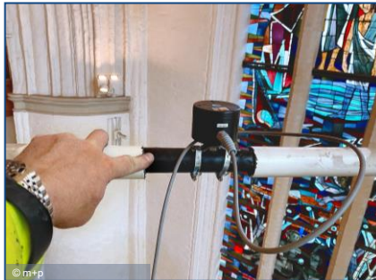
Spannstahl-Messungen, Kirche St. Katharinen, Hamburg
