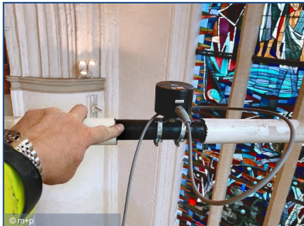
Spannstahl-Messungen, Kirche St. Katharinen, Hamburg
